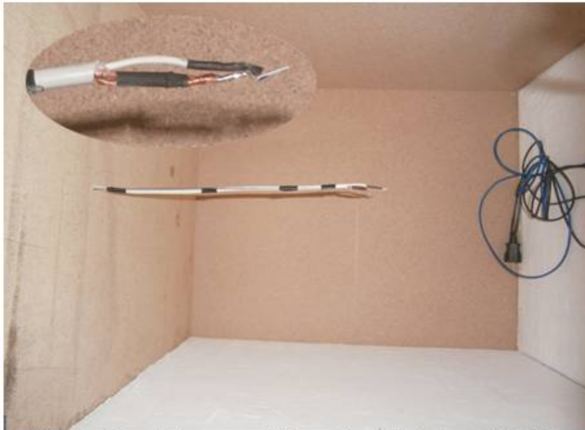
Slika 6. Unutrašnjost test modela – prikaz položaja sonde PT100
