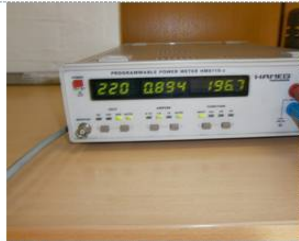
b) Izlazne vrednosti iz autotransformatora
