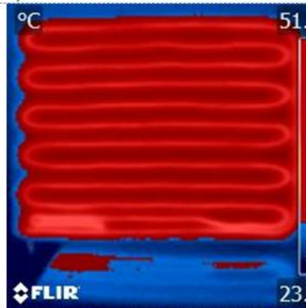
d) Termografski prikaz grejnog panela sa zadatom donjom graničnom vrednosti temperature
